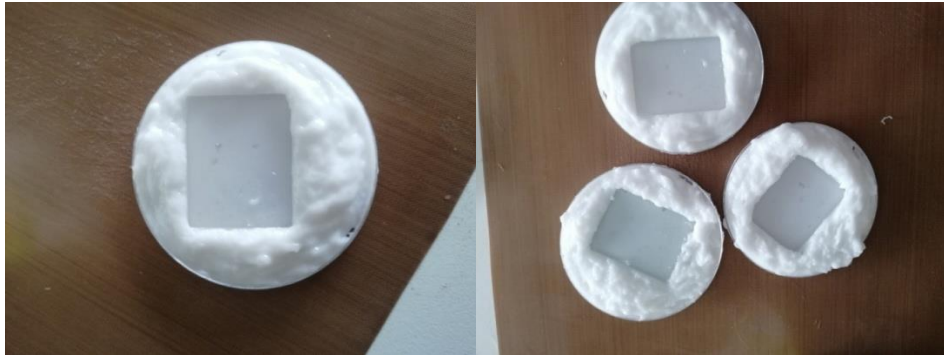
Şekil 11. Kompozit malzeme üretiminde kullanılan silikon kalıplar
